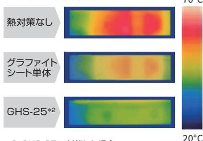
\*2:GHS-25 で対策した場合、熱対策なしと比較すると、CPU 温度も 3.2℃ 低下。
